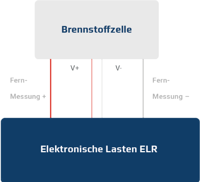
Abbildung 4 Testaufbau zum Messen des Brennstoffzellenwiderstands mit dem Stromunterbrechungsverfahren
